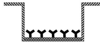
图1. 预包被IgG抗体微孔板 孔板上预包被了抗兔IgG特异性抗体。
